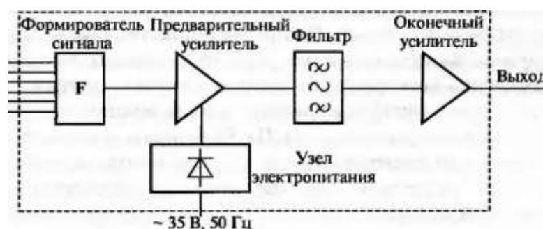
Рис. 1. Блок-схема путевого генератора ГПЗ
