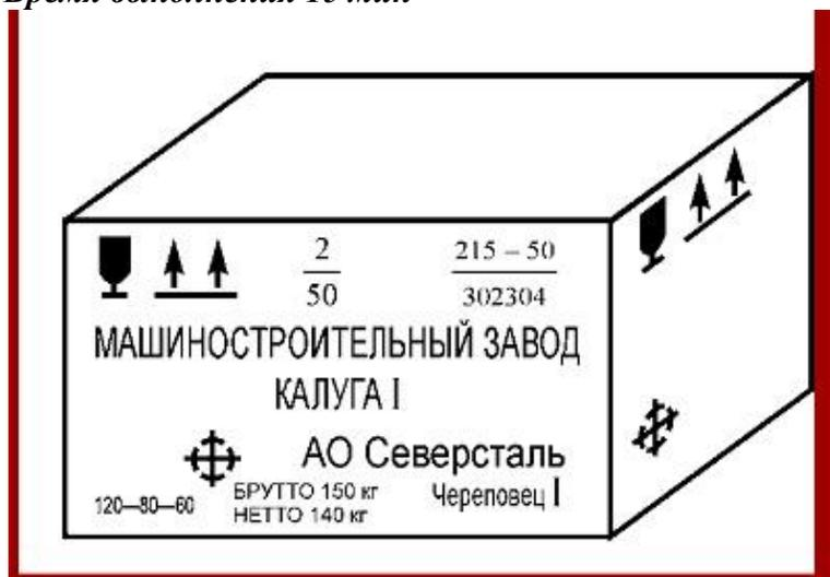
Маркировка, наносимая непосредственно на ящик
