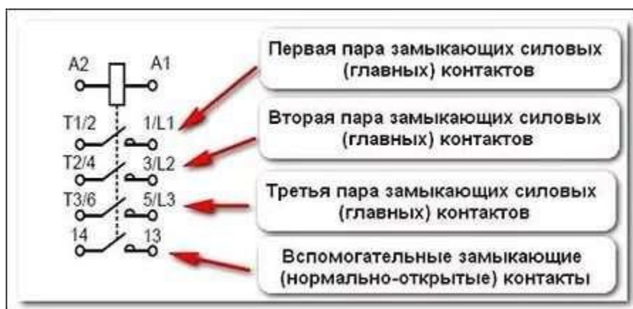
Схема магнитного пускателя ПМЛ-1100
